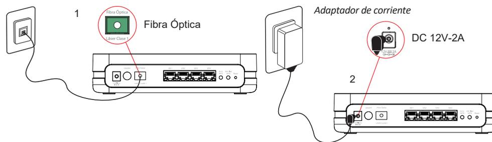
**Atención:** el cable de Fibra Óptica que conecta tu equipo con la roseta es muy delicado. Te aconsejamos no manipular ni tirar con fuerza del mismo para evitar su ruptura.
